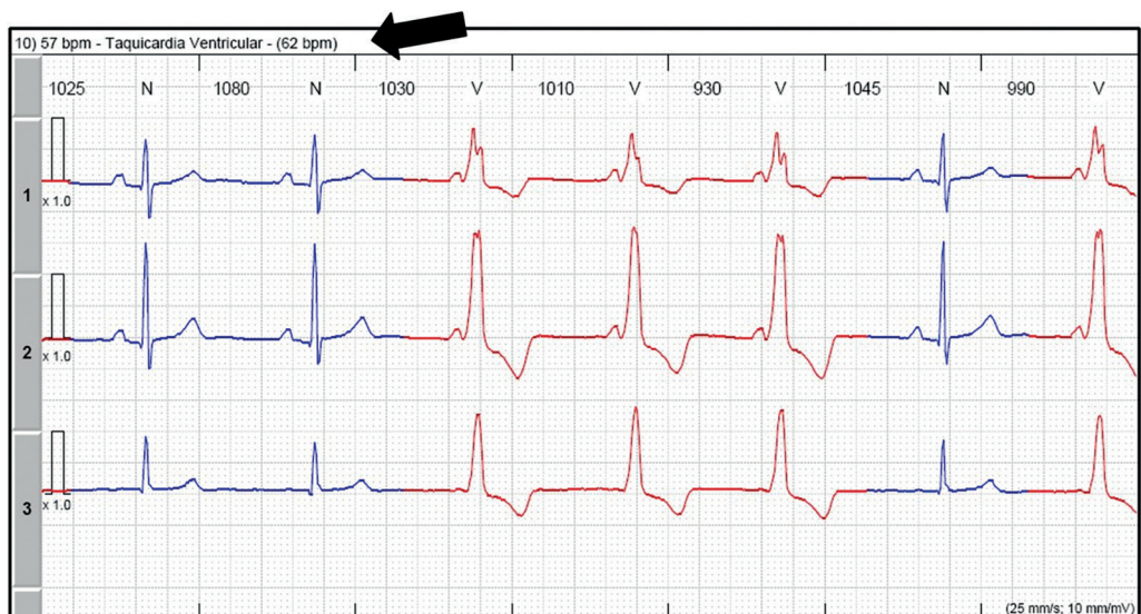
Figura 1.7. Batimentos com pré-excitação intermitente (WPW) classificados erroneamente como ventriculares pelo sistema analisador. Fonte: acervo dos autores.
